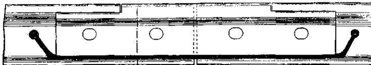
400. Электрическое скрепление рельсовъ.
