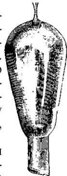
179. Стеклянный колпачекъ съ трубкой для выкачиванiя воздуха.
