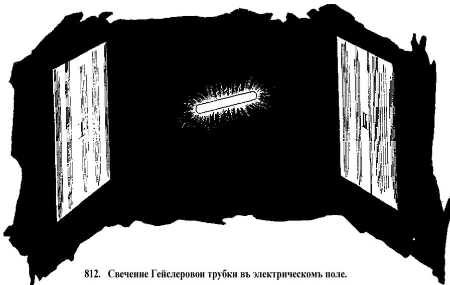
812. Свечение Гейслеровой трубки в электрическом поле.
